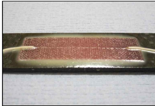
<그림 2-2> CFRP 시편에 적용된 센서 패치 (3)
